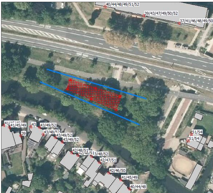
Figuur 9 Locatie 2: langtijdgemiddelde beoordelingsniveau ( L_{Ar,LT} ) etmaalwaarde in het worst-case scenario (drukke zomerse dag), inclusief schermen.
