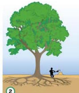
2 Graafwerkzaamheden binnen de kroonprojectie zoveel mogelijk handmatig en/of met aangepast materieel, maar altijd onder deskundig toezicht.
