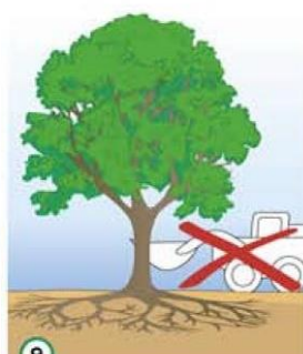
9 Rijd nooit met zwaar materieel over de wortelkuit. Dit leidt tot verdichting en verstikking van de bodem met wortelsterfte als gevolg. Is dit onvermijdelijk, plaats dan sloopshuiden op een bed van grof zand.
