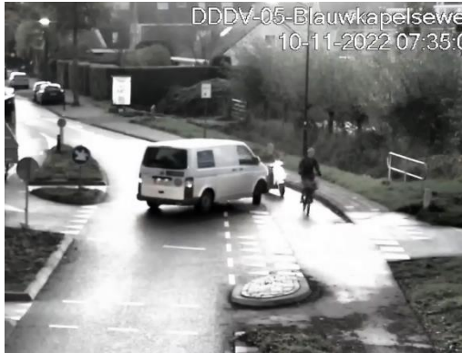
Afbeelding 60: Conflict: een automobilist keert ter hoogte van de bussluis om, op de goede weghelft te gaan rijden, maar komt hierdoor in conflict met een bromfietser en fietser die op de verkeerde weghelft fietsen
